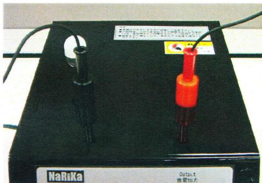
写真5. 放電針を外してケーブルを接続
